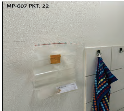
Bild 22: MP607-Pkt. 22, EG/OG/KG, Wandputz innen -- Mischproben
